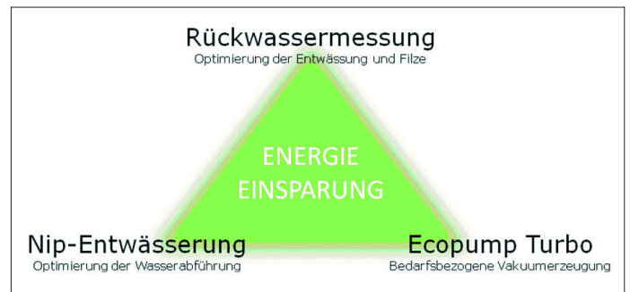
Abb. 3: Energieeinsparung mit bedarfsbezogener Vakuumherzeugung nach Optimierung der Vakuumstellen
