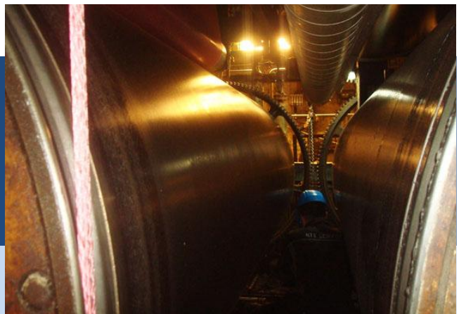
Danach: Die Zylinderoberfläche ist so gut wie neu.
