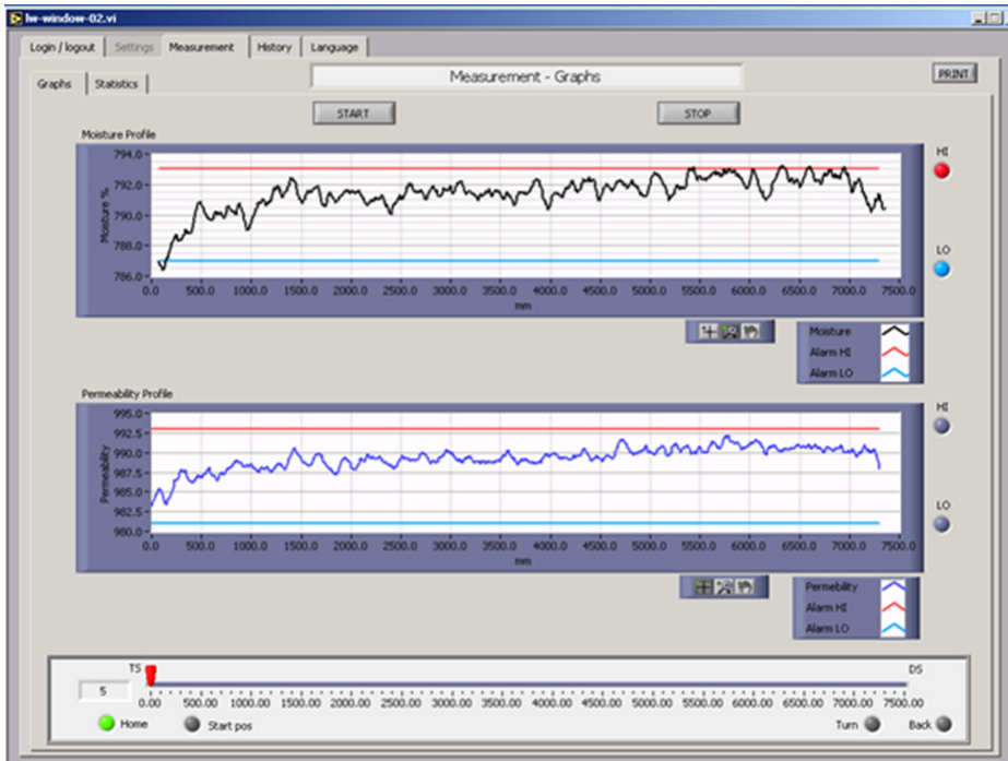
Abbildung: Online-Filzmessung von Permeabilität und Feuchtegehalt
