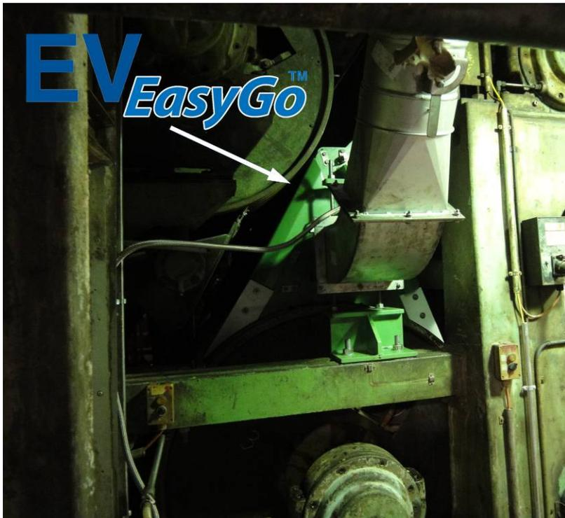
Abbildung 2: EV EasyGo® Bahnstabilisator mit gebohrtem unteren Zylinder, Sappi Stockstadt PM 1
